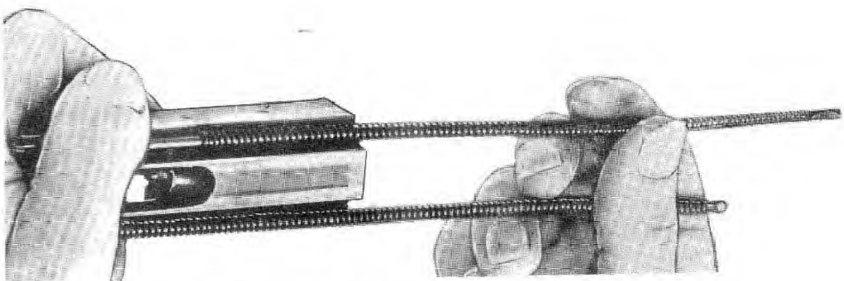
Sl. 65 – Odvajanje povratnih opruga od sklopa zatvarača
